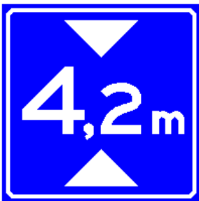
Afbeelding 53 Bord L 1: Hoogte onderdoorgang.
